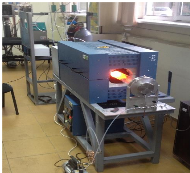
6 Сурет - а) CVD схемалық көрінісі, б) Графен синтезі кезіндегі CVD реакторы[22]
