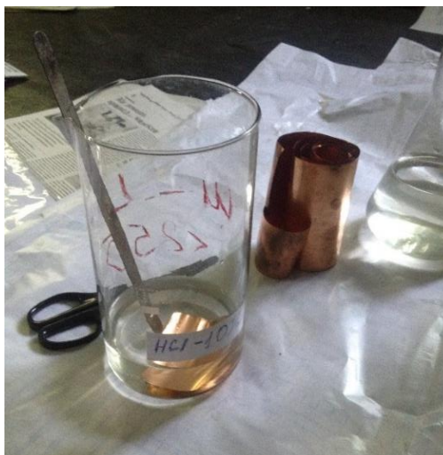
5 Сурет – 5x5см мыс фольгасын HCl ерітіндісімен тазалау
